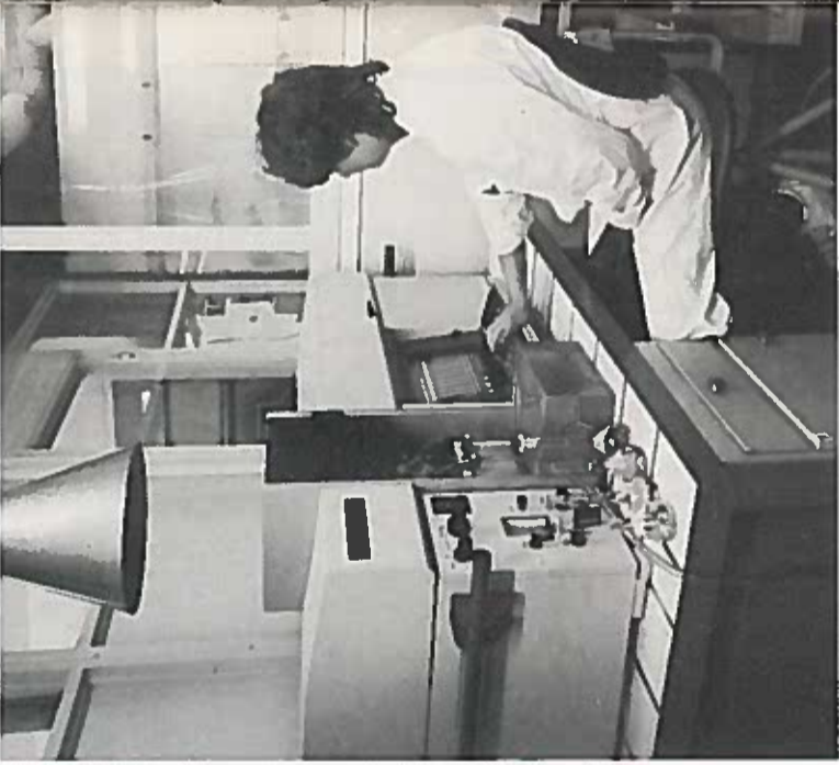
La "bulle" où est installé l'appareil d'absorption atomique. Mlle Fourneau examine les courbes d'étalement imprimant.
